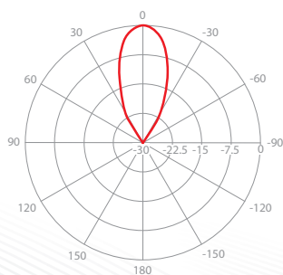
V/H - Patrón Azimuth 5.6 GHz
