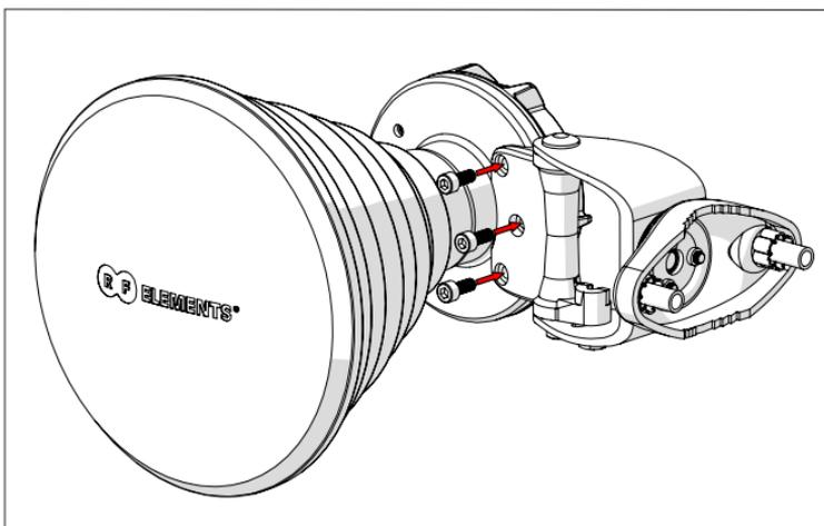
Modelo HG3-TP-S30 mostrado. Las instrucciones de instalación son idénticas para los demás modelos de las horns simétricas. Las dimensiones de la antena pueden cambiar.
