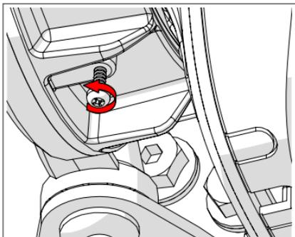
desatornillelo unos 10 mm antes de desbloquear el mecanismo del TwistPort™
